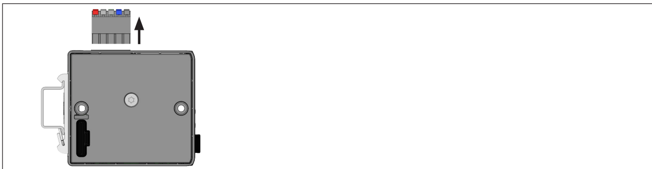
Fig.35: Remover o borne à mola de 5 pinos
